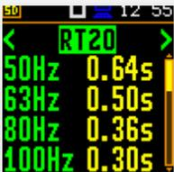
**RT60 ANÁLISIS** que proporciona un cálculo del tiempo de reverberación para bandas de 1/1 de octava (de 63 Hz a 8 kHz) o bandas de 1/3 de octava (de 50 Hz a 10 kHz) y tres niveles RMS totales (ponderados A, C y Z). Todo el proceso de medición y los cálculos implementados en SV 973 cumplen con la norma ISO 3382. Se puede activar en cualquier momento solicitando el código de activación.
